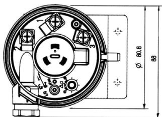
Штуцер P1 для подключения высокого давления
